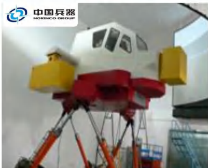
中国兵器集团某所 直升机载武器站综合模拟台 模拟直升机飞行姿态及气流和发动机 引起的颠簸和抖振 国家“高新工程”项目
