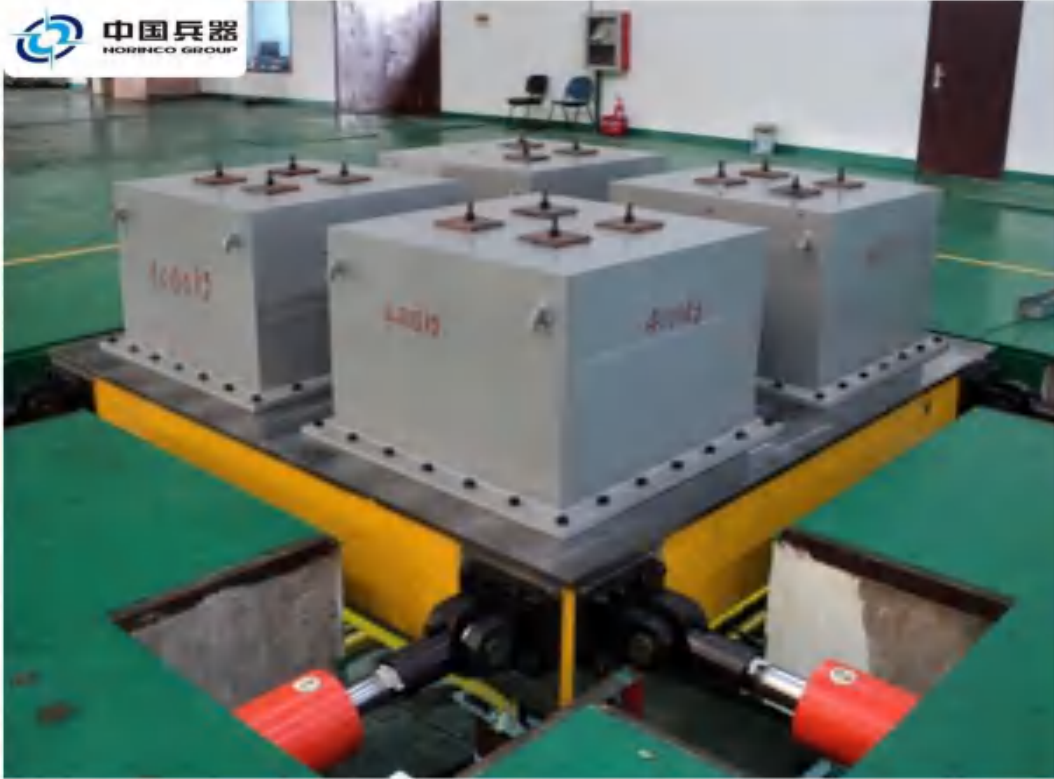
中国兵器集团某所 三轴六自由度振动试验系统 国家高新工程项目 模拟车辆行驶状态下，车辆和车载设备的振动和摇摆环境
