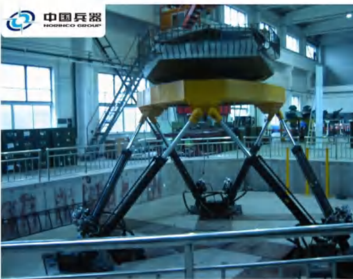
中国兵器 NOBORICO GROUP 中国兵器集团某所 六自由度运动模拟器 国家“高新工程”项目
