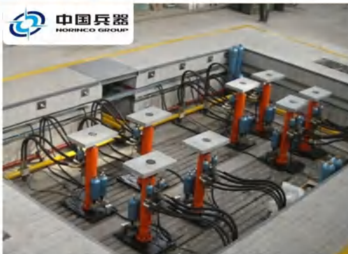
中国人民解放军某研究所 八立柱道路模拟试验系统
