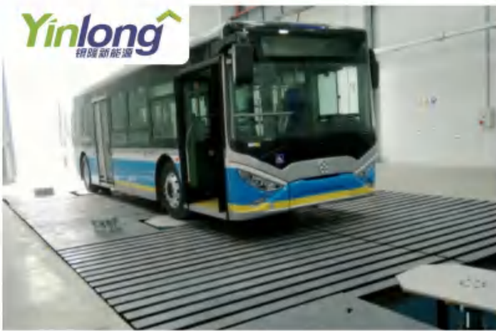
Yinlong 银隆新能源 广东珠海银隆客车 六通道道路模拟试验系统
