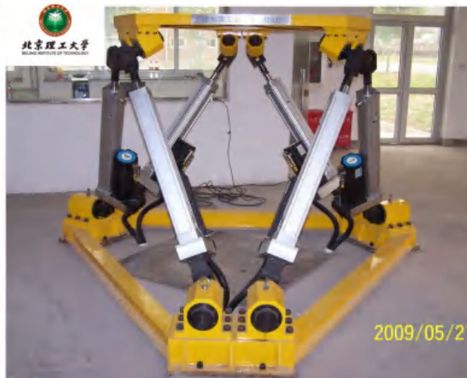
北京理工大学 六自由度运动试验台 可实现正弦波、矩形波、及随机谱 的输入和运动复现
