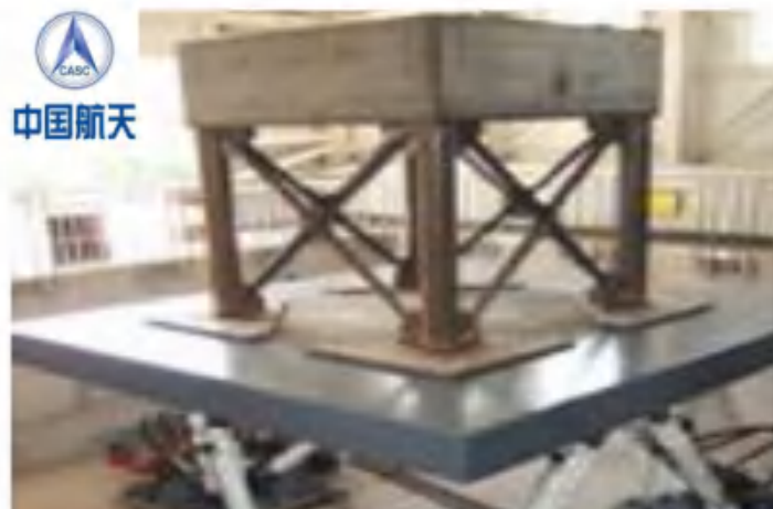
航天某部 舰船运动模拟系统 国家“高新工程”项目 可模拟5级海况下舰船运动姿态 台面可在任意姿态下承受30T冲击
