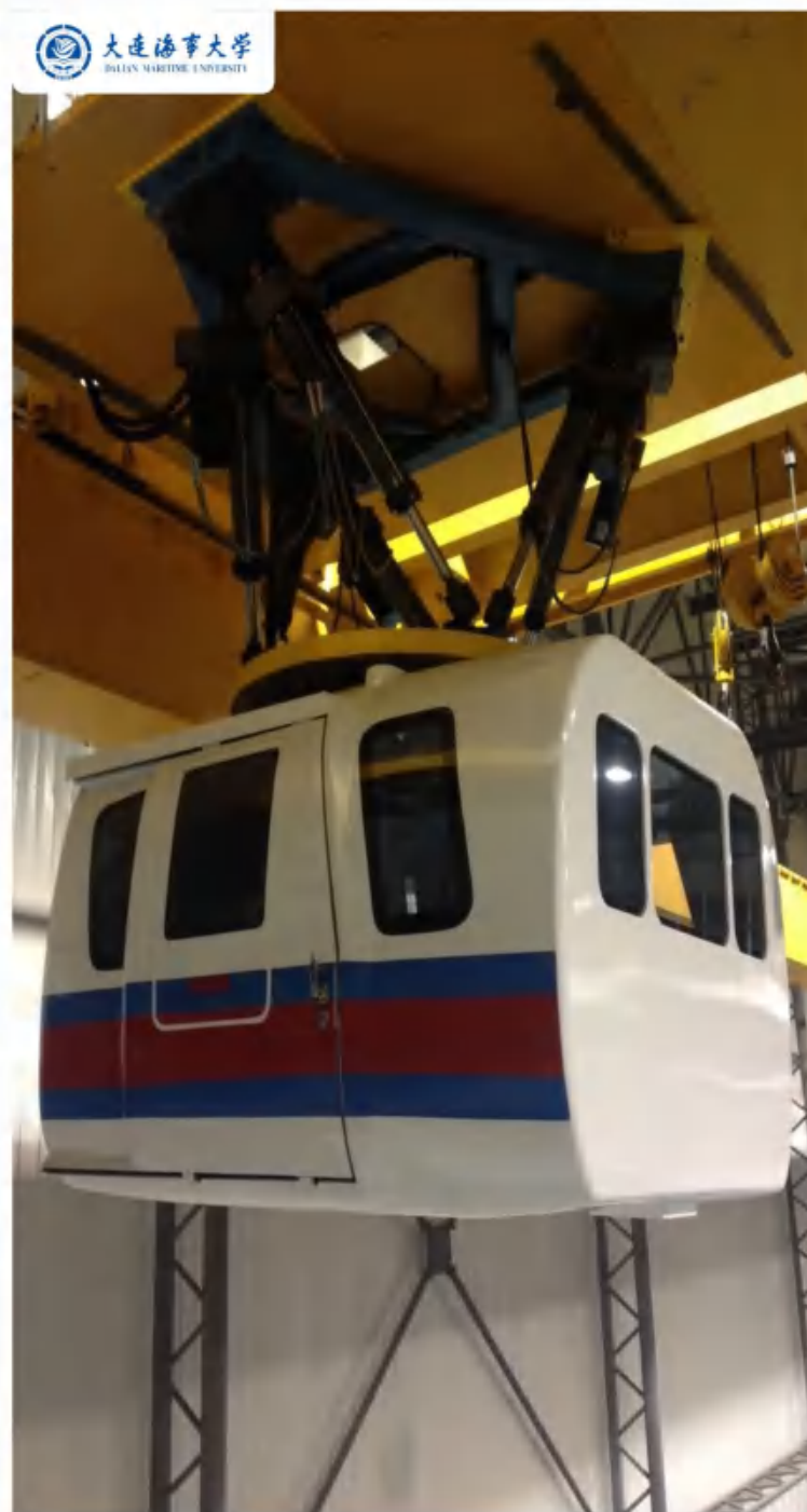
大连海事大学 直升机模拟搜救试验台 实现直升机悬停救助过程的动感再现
