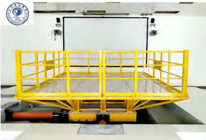
山东地震局 地震模拟振动试验台
