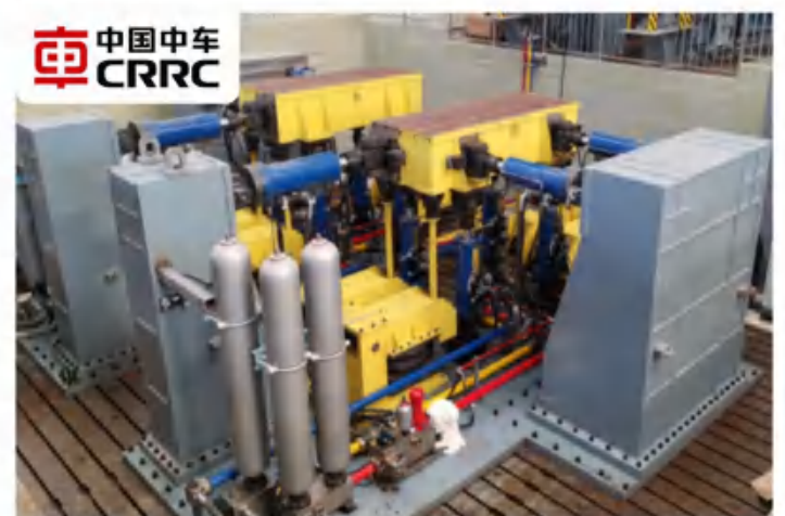
中国中车 CRRC 中国中车集团某研究所 传动系统综合性能试验台 再现车辆实际线路运行过程中机械传动、电气传动等实际运行工况，可以满足对轨道车辆传动系统或关键传动部件如电机轴承、传动轴承、齿轮箱等进行匹配性、安全性、可靠性试验测试需求
