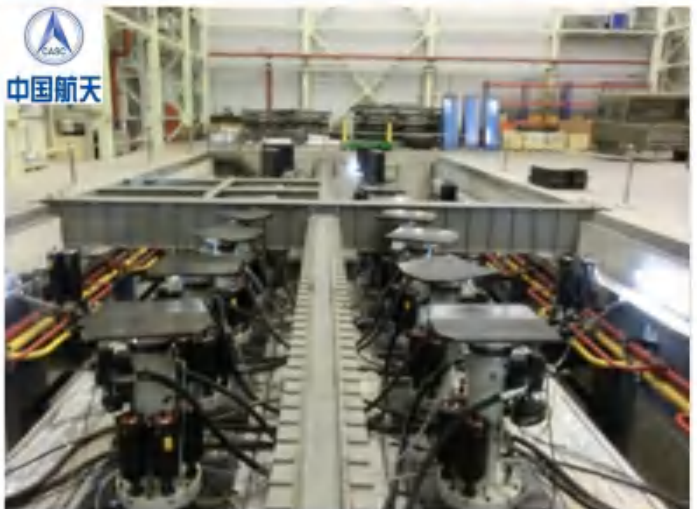
中国航天集团某研究所 十六立柱道路模拟试验系统
