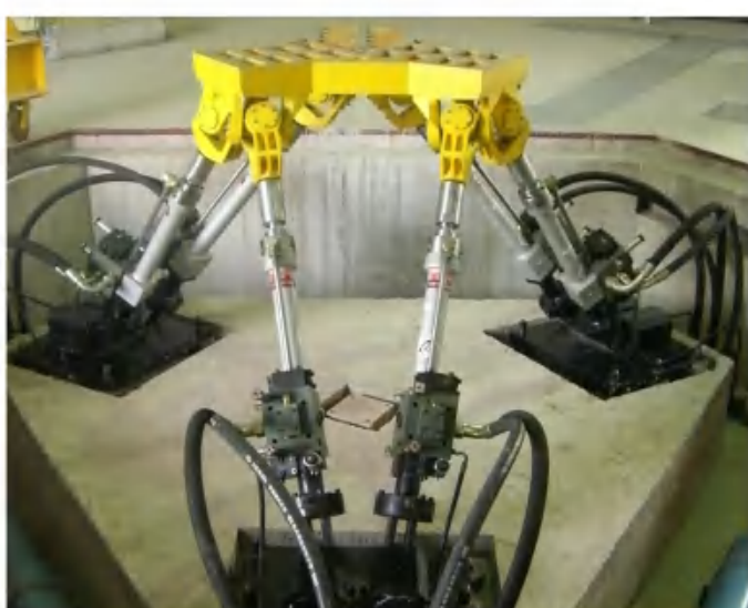
总装某基地 六自由度运动模拟系统 国家高新工程项目 模拟直升机的运动姿态 检验机载光学设备动态性能
