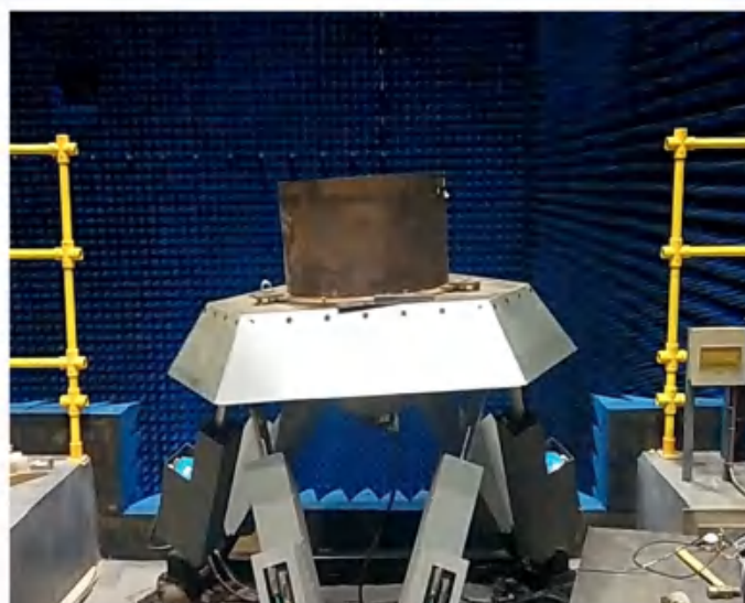
中国电子科技集团某所 七自由度运动模拟系统 运动控制点在平台上表面中心 以上0.9m处
