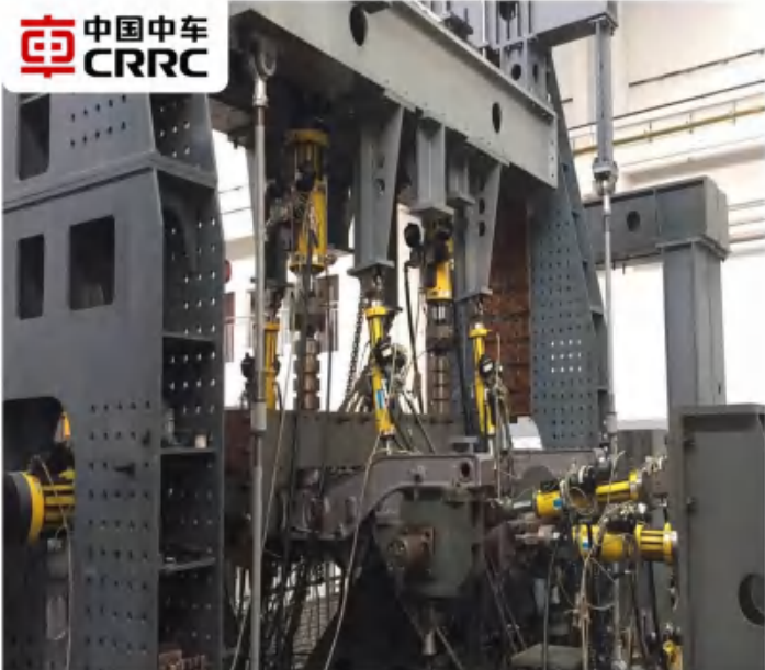
中国中车 转向架静强度及疲劳试验系统 项目特色： 24通道协调加载，全套系统自主研发 解决通道间的耦合作用
