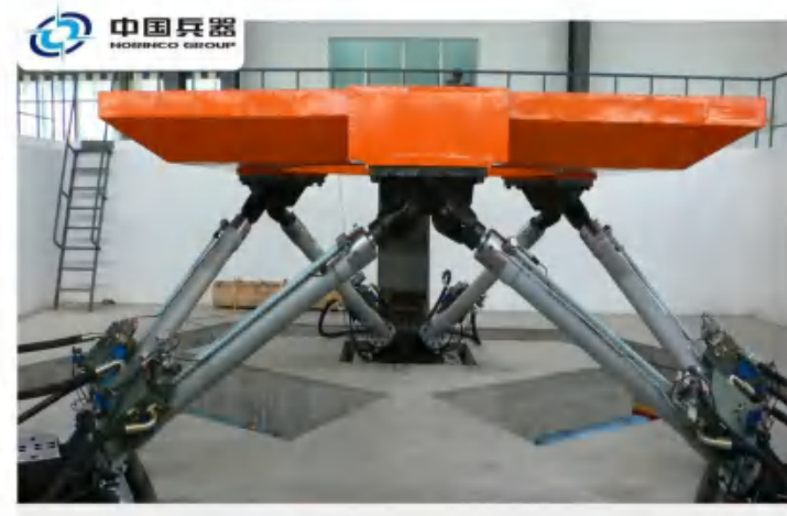
中国兵器 NOBORICO GROUP 中国兵器集团某厂 六自由度动态试验台 国家“高新工程”项目 模拟军用特种车辆在行进状态下的工作状态
