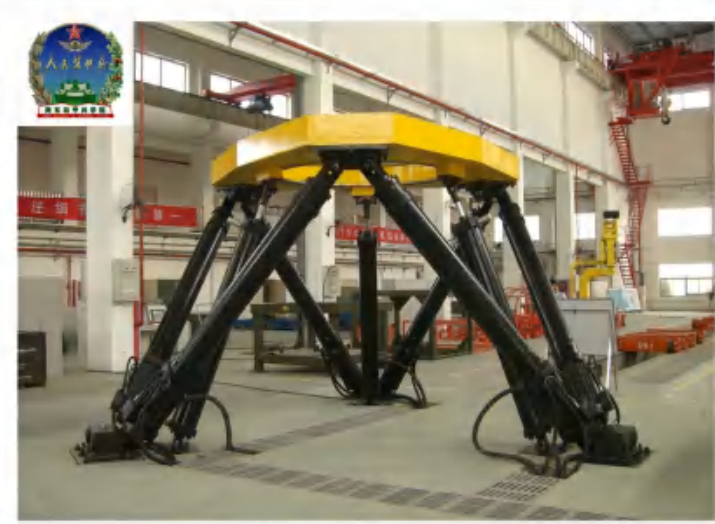
中国人民解放军 中国人民解放军某学院 电动六自由度摇摆台，设置三个气动 辅助支撑作动器
