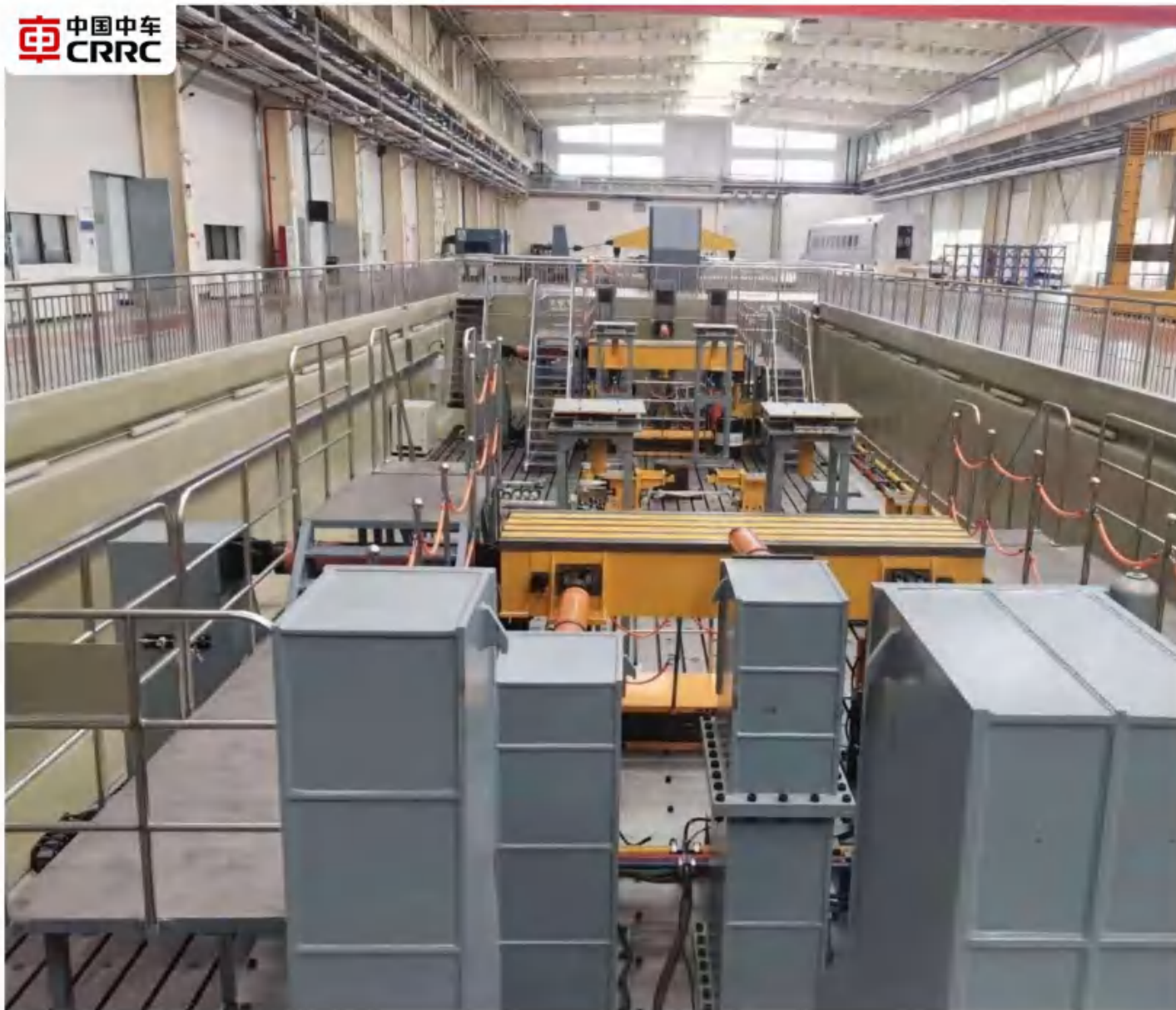
中国中车 CRRC 中国中车集团某研究所 牵枕缓结构疲劳试验台 满足各种地铁、动车组、城际等车辆牵枕缓结构静强度、疲劳试验要求，也能进行给定载荷（实车测试载荷）条件下的随机加载试验（路谱再现），同时对动车组车钩进行疲劳强度试验研究
