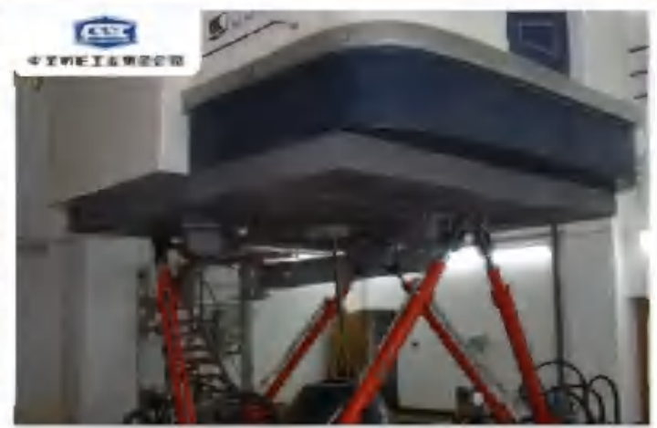
中国船舶集团某研究所 六自由度航海模拟器 中船总95保障项目
