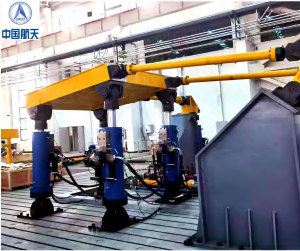
中国航天集团某研究所 多自由度振动特性模拟试验系统 通过模拟车辆在不同工况下驾驶室等总成的多自由度的振动，进行相关总成的振动环境适应性试验、疲劳耐久性试验
