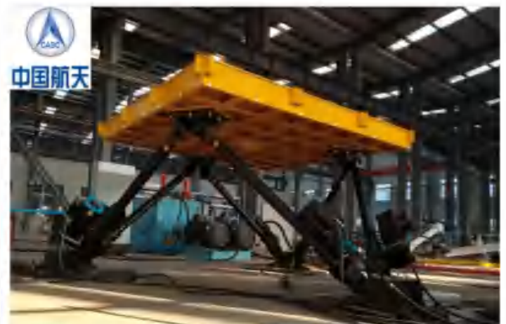
上海某研究所 6自由度转台 模拟发射平台行驶环境，对发射平台 的上装负载进行相应试验。
